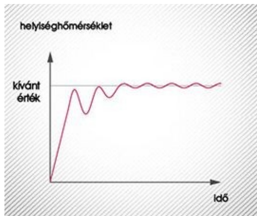
7.6 ábra PI-szabályozóval optimálisan beállított szakasz idődiagramja (vgfszaklap.hu)
